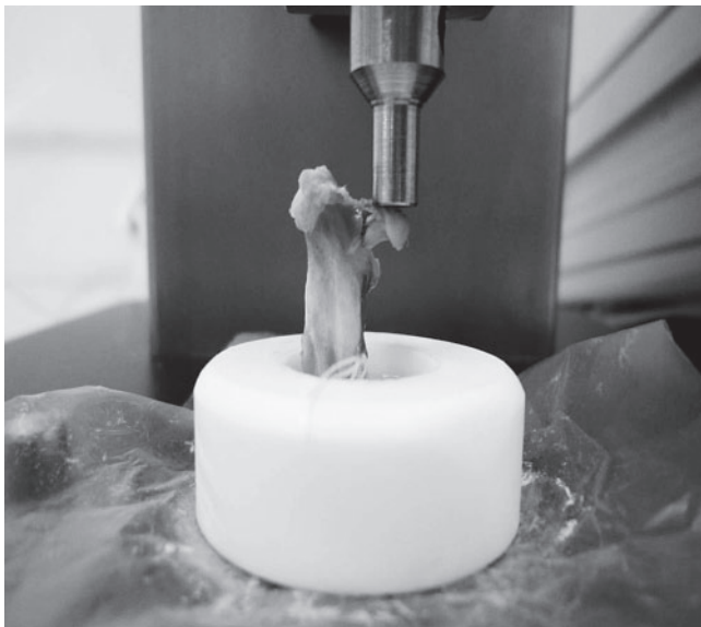
Obr. 2 Testování odolnosti krčku femuru v tlaku
